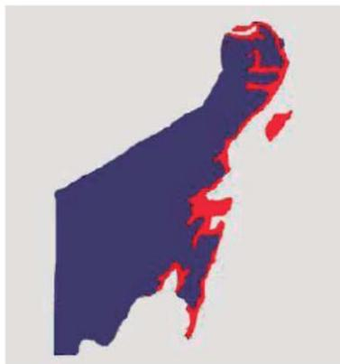
Figura 2. Zonas de riesgo de inundación<sup>46</sup> (color rojo) por aumento del nivel del mar (1-2m) en el Estado de Quintana Roo. (Fuente: INE, 2011)
